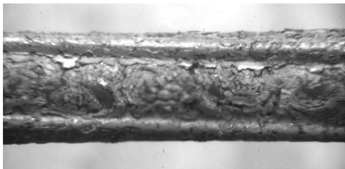
Рис. 1. Типичное коррозионное язвенное повреждение оболочки твэла из сплава Э110 после эксплуатации в реакторе атомного ледокола
